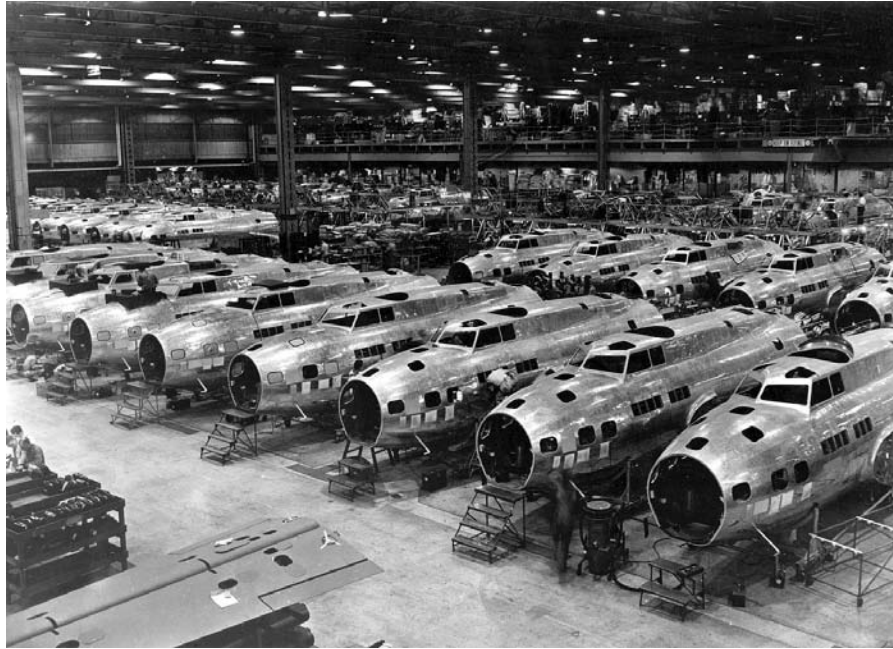
Przednie części kadłubów B-17E w hali produkcyjnej Boeinga w Seattle, 1943r Zdjęcia: Wikipedia
